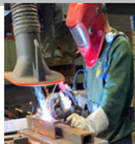
■ Mesures de fumées de soudage en atelier de serrurerie
